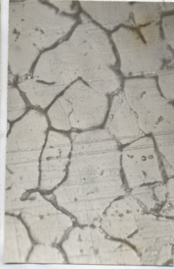
b-2) 溶着金属より 4 mm 地点 の金属組織 (鋭敏化組織)
