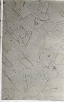
b-3) 溶着金属より 12 mm 地点 の金属組織 (非鋭敏化組織)
