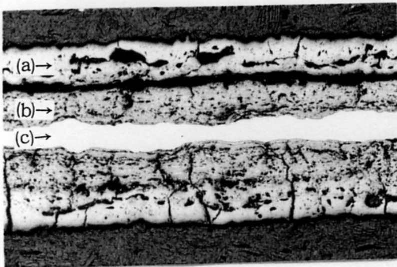
(a) 酸化スケール (外側)、(b) 酸化スケール (内側) (c) 残存金属
