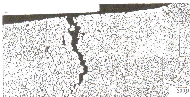
図2. 損傷部断面のマイクロ組織
