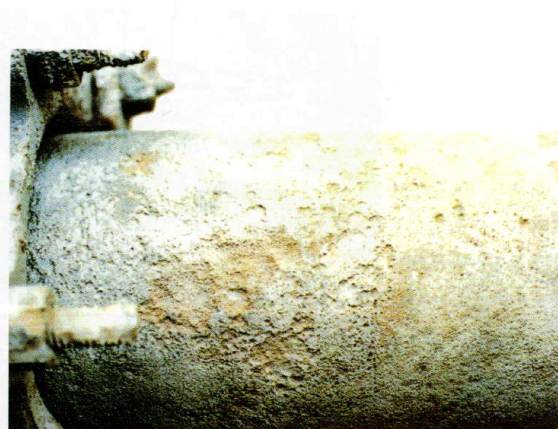
図1．硫酸塩還元細菌が棲息する粘土質土壌に16年間埋設された球状黒鉛鑄鉄管 1)
